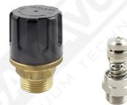
Queste valvole, costruite in ottone nichelato, sono dotate di grande robustezza e precisione e trovano vasto impiego su macchine dove la regolazione e la taratura del vuoto deve essere molto precisa. La regolazione del grado di vuoto si ottiene girando il pomello zigrinato.
